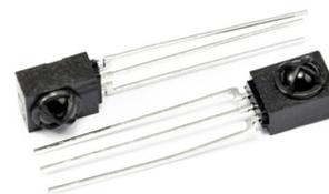
Dois recetores de infravermelhos são colocados na parte inferior da placa, ao contrário de todos os componentes que já soldaste.
