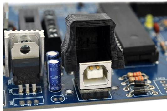
Inseres os dois parafusos M3x6mm nos orifícios e apertas-os, usando uma chave PH1, roscando-os na protecção plástica. Rosca os parafusos até a base da protecção plástica ficar em contacto com a placa do robô, mas não apertes demasiado pois podes moer o plástico!
