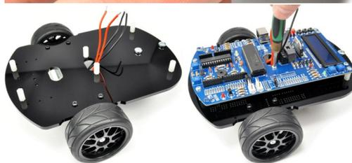
Aperta os parafusos com uma chave de cruz de forma a que não existam folgas entre a placa do robô, os espaçadores de nylon e a base de acrílico.
