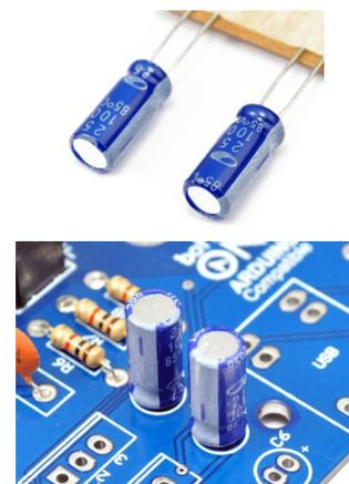
Fig. 45: Condensadores eletrolíticos
