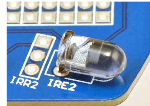
Fig. 32: LED's emissores de infravermelhos
