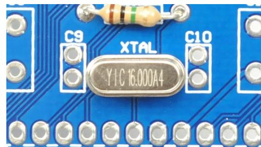
Fig. 22: Cristal Oscilador na placa
