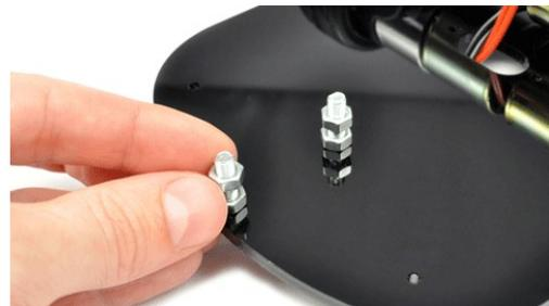
Colocas a roda fixa inserindo os parafusos nos orifícios correspondentes e rosca a última porca M5 em cada parafuso.
