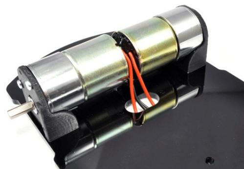
Fig. 10: Passagem dos fios dos motores pela placa de acrílico
