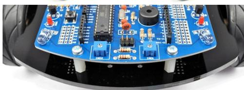
Fig. 58: Montagem da placa de circuito impresso na base de acrílico
