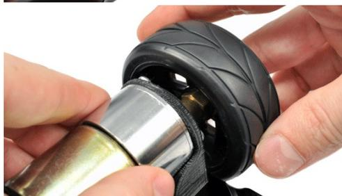
Fixa a roda ao hub usando o parafuso M4X6mm PH2 e aperta-o convenientemente!
