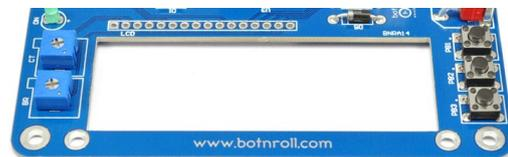
O LCD entra no recetáculo pela parte inferior da placa do Bot'n Roll ONE A. Antes de o colocares insere o conector de 16 pinos nos orifícios do LCD com os pinos mais compridos virados para baixo.
