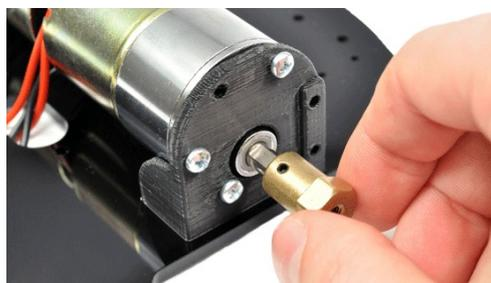
Encaixa o hub no veio do motor e enrosca o perno sextavado contra a parte lisa do veio usando a chave sextavada de 1.5mm.
