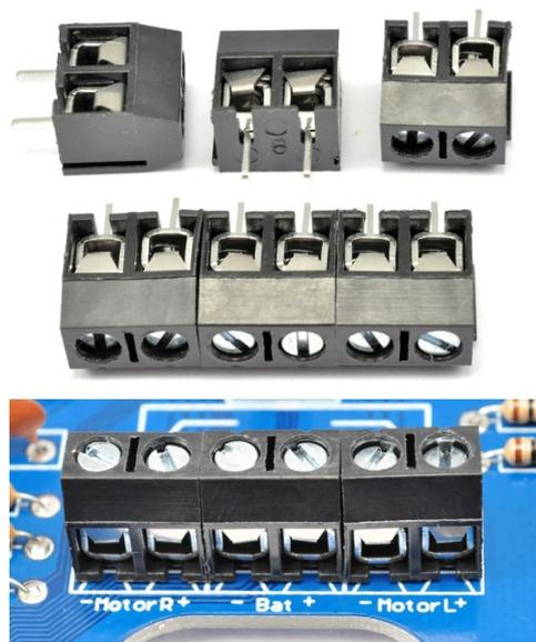
Fig. 43: Conectores de potência e sua colocação
