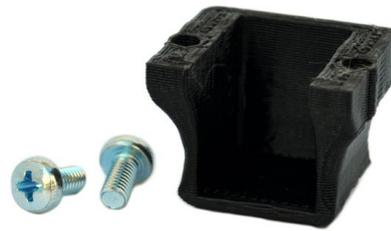
Coloca a protecção plástica no conversor USB-Série deixando visível a ligação para o cabo USB. Verifica que os dois furos na base da protecção plástica coincidem com os furos na placa do robô.
