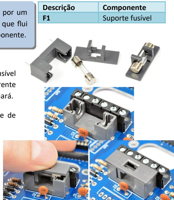
Fig. 44: Colocação do fusível no circuito
