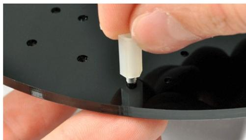
Coloca a placa eletrônica do robô passando os cabos dos motores pelo orifício da placa e fixa-a roscando os parafusos M3x4 PH1 nos espaçadores de *nylon*.
