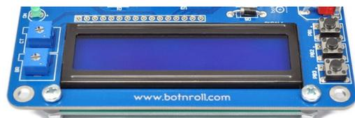
Confirma que o LCD está bem alinhado e solda os 16 pinos do conector na placa do Bot'n Roll ONE A. De seguida solda os 16 pinos no LCD, por baixo.
