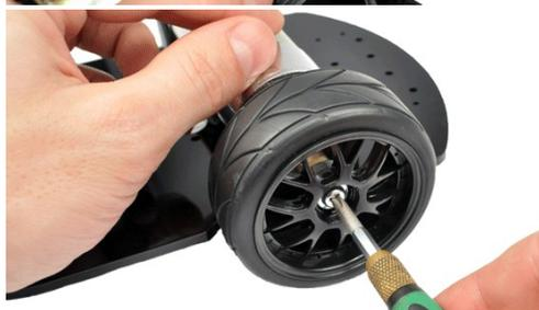
Fig. 12: Procedimento para fixar as rodas de tração
