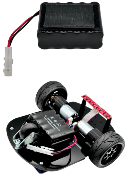
Fig. 68: Colocação da bateria
