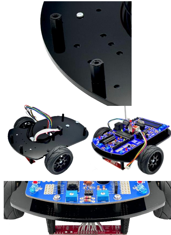
Fig. 66: Montagem da placa de circuito impresso na base de acrílico
