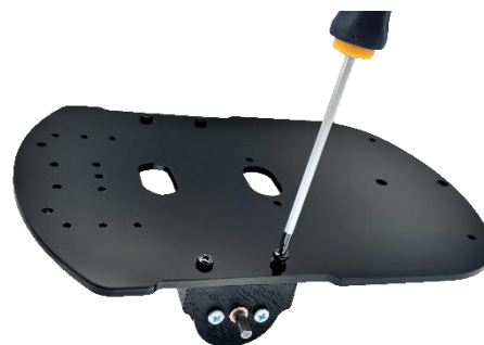
Fig. 10: Fixação dos motores à placa de acrílico
