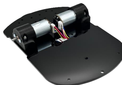
Fig. 11: Passagem dos fios dos motores pela placa de acrílico
