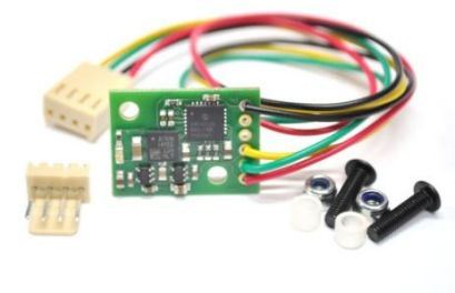
Fig. 17: Componentes para fixação e ligação eléctrica da Bússola
