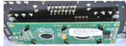
Fig. 10: Inserção do LCD
