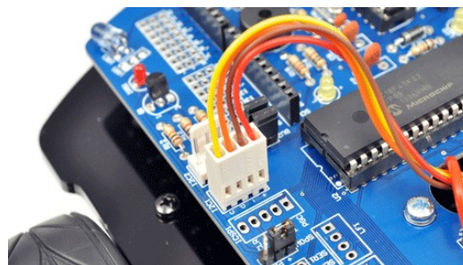
Fig. 10: Ligação elétrica da bússola
