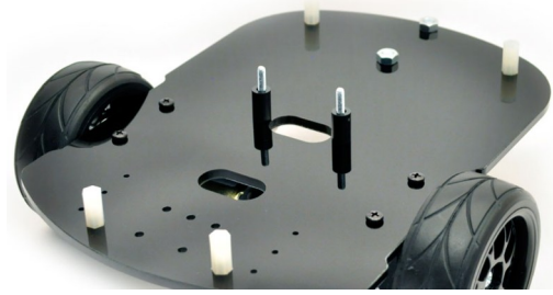
Fig. 17: Parafusos M3x25mm e espaçadores centrais
