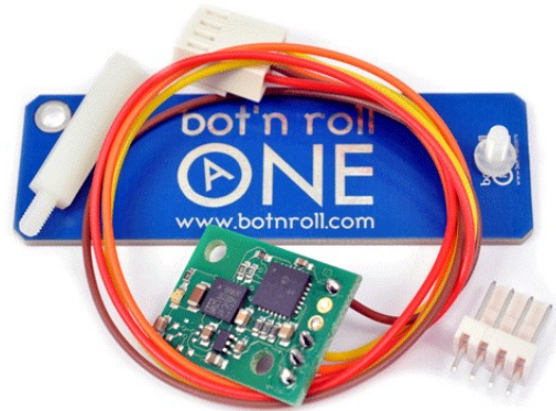
Fig. 7: Bússola CMPS12 e acessórios para colocação no Bot'n Roll ONE A
