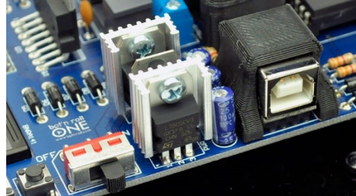
Fig. 24: LM7805 e dissipador
